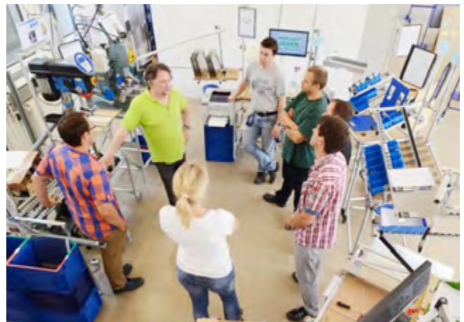
Als Team setzen die Teilnehmer des Workshops am CETPM die Optimierung einer Produktionslinie mit dem Profilrohrsystem D30 von item um
