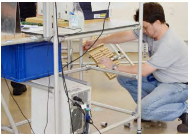
Durch die Verwendung von leichtem und stabilem Aluminium sind kleine Umbauten problemlos von einer einzigen Person umsetzbar
